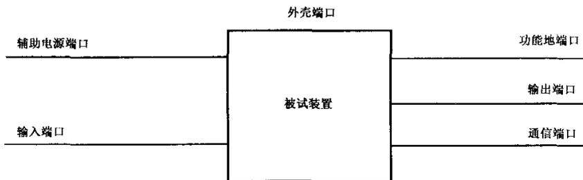
图 1 保护装置的端口示意图
