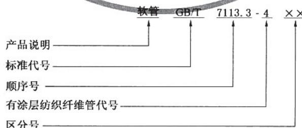
在本部分中,区分号为 06、07、08,有涂层纺织纤维管代号“4”加上区分号“06”、“07”、“08”组成的“406”、“407”、“408”分别对应于“高击穿电压”、“中等击穿电压”、“低击穿电压”品种型号。
