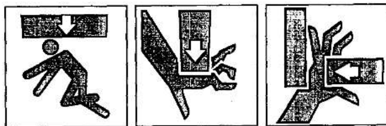
图 D.23 用箭头表示施加的压力或者作用力的图形符号示例
