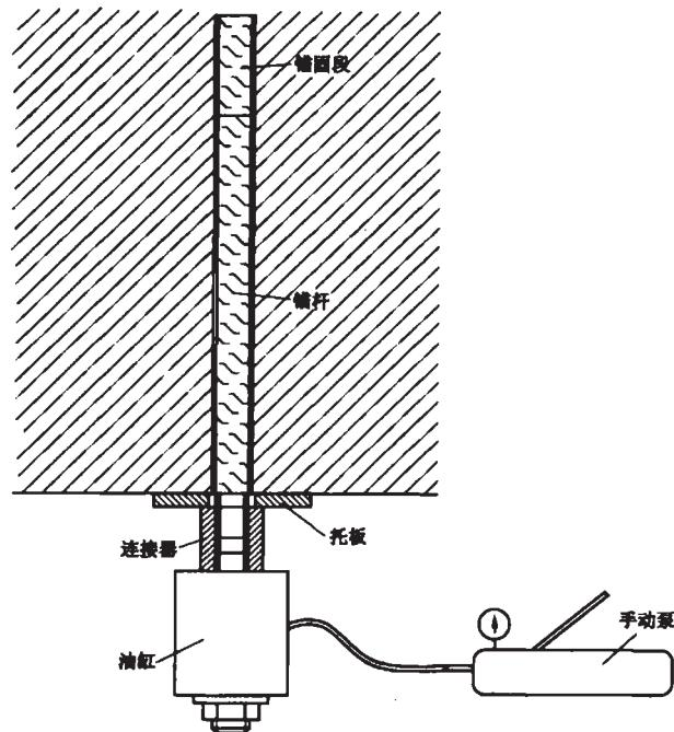
图 A.1 锚杆拉拔试验示意图
