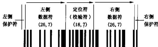
图8 限定式RSS符号结构示意图
