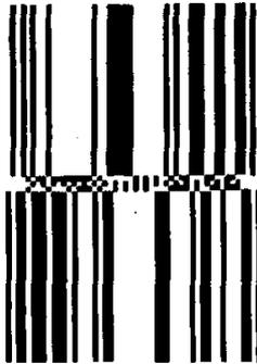
图 6 表示数据(01)00034567890125 的全向层排式 RSS-14 符号
