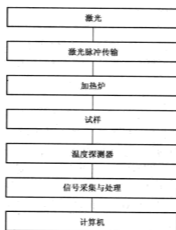
图2 闪光系统示意图
