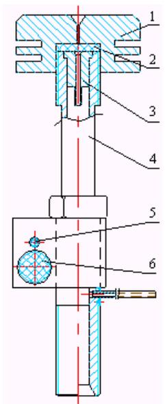
图 1-4: GC9860 网络气相色谱仪进样器结构示意图
