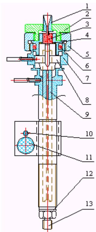
图 1-5: 隔膜清扫分流进样器结构示意图
