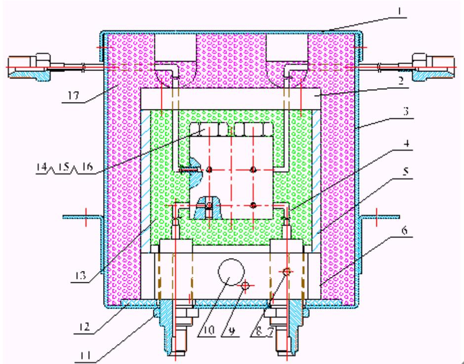
图 1-6: TCD 检测器结构示意图
