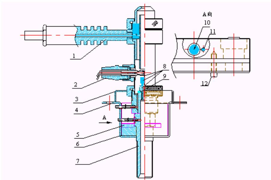
图 1-7: FID 检测器结构示意图
