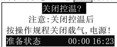
此时按**输入**键，即关闭控温。此时会听到仪器内部有继电器施放的响声，后开门会自动打开进行降温。
