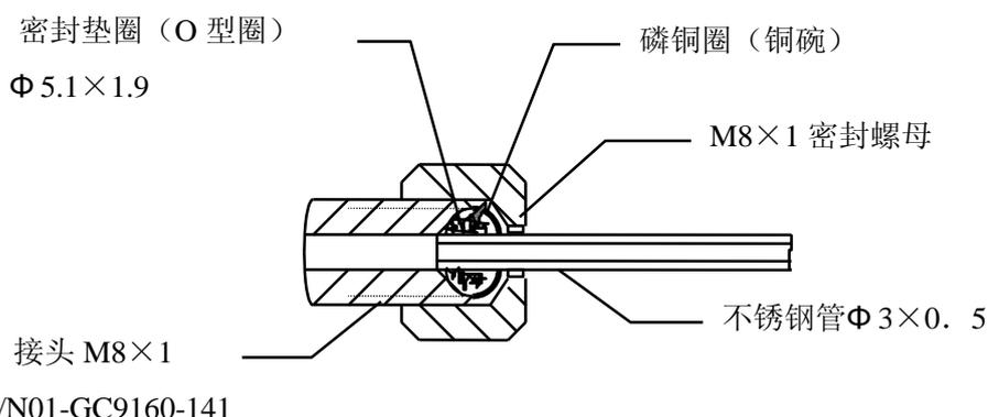
图 2-3: 金属管气路连接示意图
