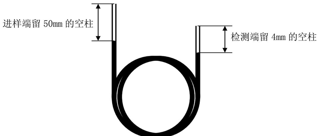
图 6-1 填充柱两端留空管部分示意图
