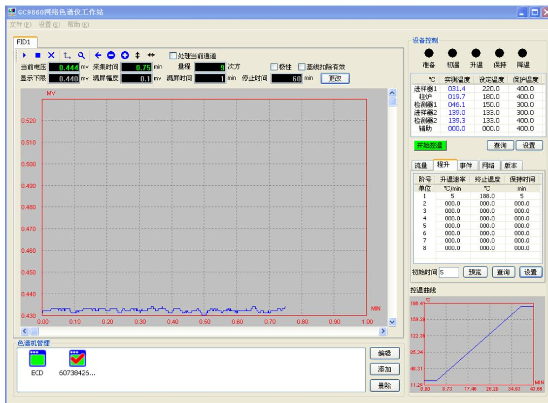
界面的上方是下拉式菜单；下方是检测器的运行参数和屏幕显示参数；中部是基线显示区；最下方是色谱仪状态指示区；右面是色谱仪的运行参数。
