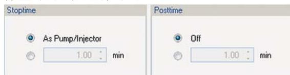
停止时间是整个系统停止（如，泵 / 进样器停止）或模块停止（如果与系统停止时间不同）的时间。数据收集会在此时停止。您可以利用后运行时间使模块的项目达到平衡（例如，梯度改变或温度改变之后）。
