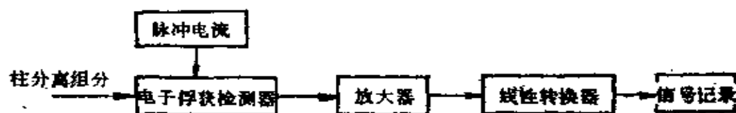
图 32 电子俘获检测器原理方框图
