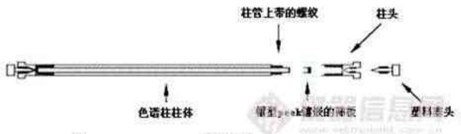
图 2. Modular Column 基本构造
