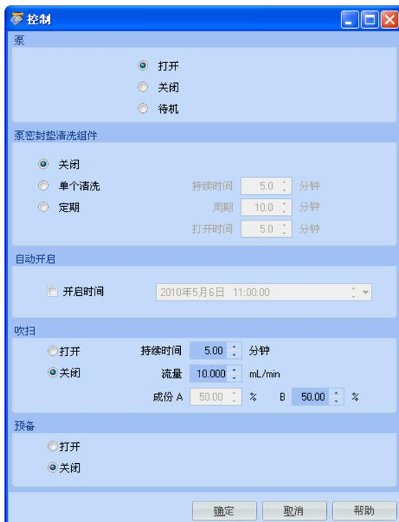
3. 勾选**吹扫**, 并且输入流速, 时间, 比例就可以 **purge** 泵头。排空的时候阀会自动切换, 无需人为介入。
