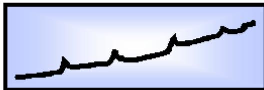
如果固定相破坏,流失严重,必须更换新的色谱柱。
