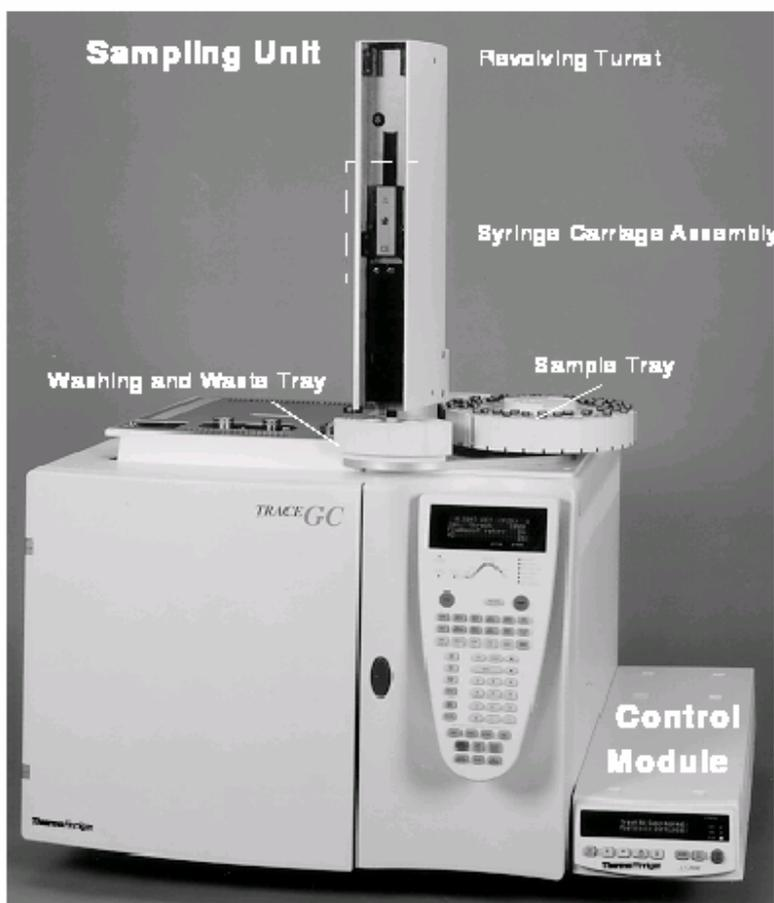
图2-1：AS2000自动进样器
