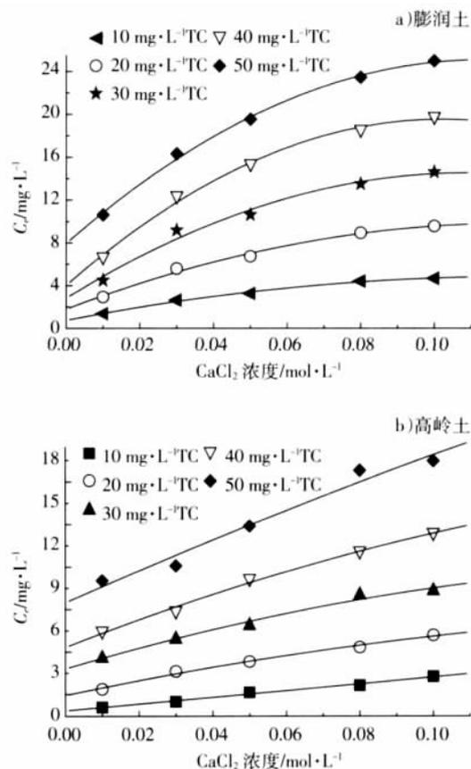
图 3 不同 CaCl<sub>2</sub> 浓度下两类粘土中四环素吸附平衡溶液浓度
