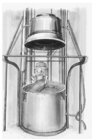
图7 甑桶与顶盖夹套冷却设备
