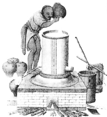
图1 1790年的酒工图,工人将发酵好的酒醪倒入蒸馏桶加火蒸馏
