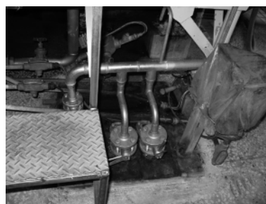
图9 蒸馏出酒管有两个开关,可控制不同馏分进入贮罐
