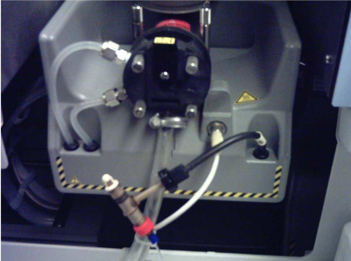
图 21. PerkinElmer 的可调雾化器
