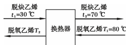
图 1 脱氧乙烯与脱炔乙烯热平衡示意
