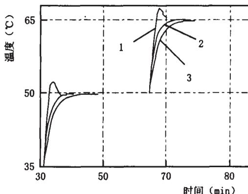
曲线 1——PID 控制作用较强时温度输出; 曲线 2——采用大林控制时温度输出; 曲线 3——PID 控制作用较弱时温度输出。
