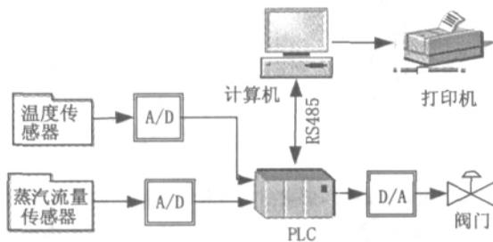
图 5 糖化温度控制系统硬件构成图
