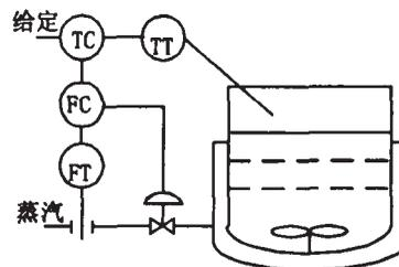
图 3 糖化温度控制系统结构图
