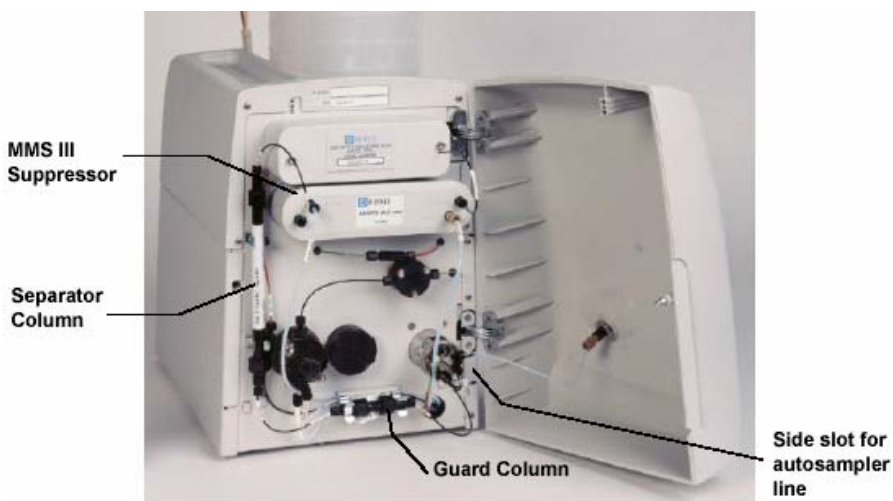
图 41. ICS-90 的组件安装示意图
