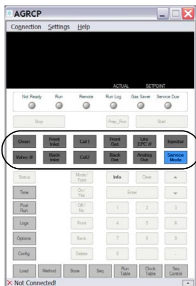
这些键用来设置温度、压力、流量、流速及其他的方法操作参数。
