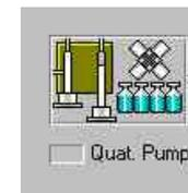
要进行泵故障诊断，用鼠标单击Quat. Pump图标，然后选择Show Module Test选项，进入泵诊断画面。
