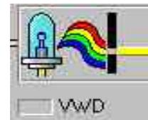
要进行VWD故障诊断，单击VWD图标，选择Show Module Tests，进入测试选项对话框：
