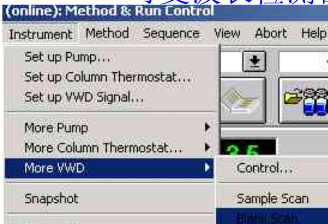
进样后，流动相流经流通池，给出色谱基线信号时，点击**More VWD**菜单中的**Blank Scan**，扫描空白流动相的吸收光谱，如下图所示。
