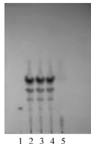
图 4 消炎洗散中紫草 TLC 图谱 1. 紫草对照药材 2~4. 供试品 5. 紫草阴性对照
