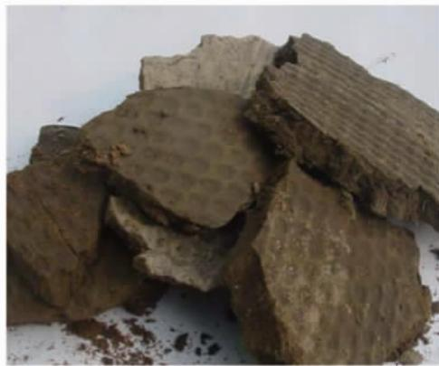
图 5 生物沥浸污泥经厢式压滤机脱水后的污泥饼
