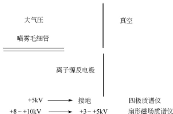
图 2-24 ESI 喷雾毛细管与离子源反电极之间的电压
