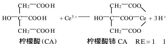
此时,每个与 Ce 原子配位的氧原子上都含有 2 对孤对电子,当形成 1:1 的离子型螯合物时,3 个与 Ce 原子配位的氧原子共含有 6 对孤对电子,容易占据 d, f 上的空轨道,使能量降低。由于在所有配合物的形成过程中,能量最低的形状为球状,并且 Ce( )离子中心到配体的各个方向受力相等,因此柠檬酸和 Ce( )离子配合物最终缩聚为类球状。
