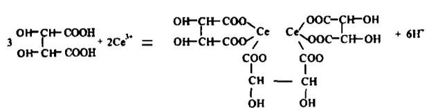
根据反应方程,我们认为酒石酸根离子与 Ce( ) 配位成键的方向沿着 Ce<sub>2</sub>(C<sub>4</sub>H<sub>4</sub>O<sub>6</sub>)<sub>3</sub> 中 6 个氧原子方向取向叠加,由于生长基元在 6 个方向叠加速率相同,最终产物为立
