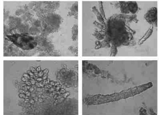
图 8 BF 填料上污泥显微镜照片
