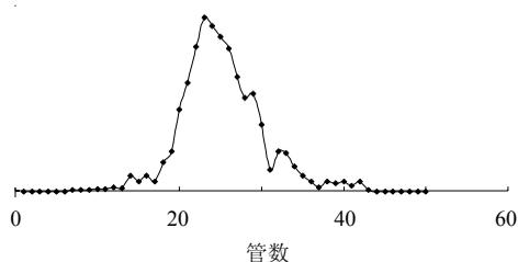
图 1 NCP 的 Sephadex G-100 柱色谱洗脱图
