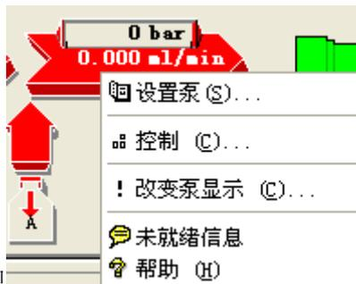
左键单击泵图标, 出现
