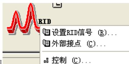
左键单击示差检测器图标，出现
