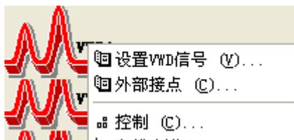
，点击“控制”或者点击“仪器”的下拉菜单“更多 VWD”中选取“控制”后进入可变波长紫外检测器的控制菜单
