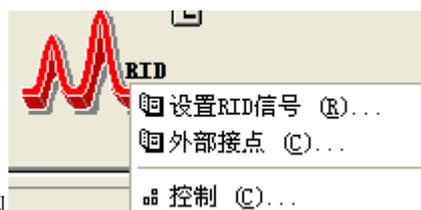
左键单击示差检测器图标，出现
