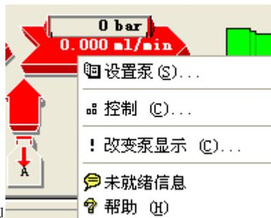
，点击“控制”或者点击“仪器”的下拉菜单“更多泵”中选取“控制”后进入泵的控制菜单
