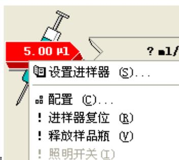
左键单击自动进样器图标，出现\_\_\_\_\_，点击“设置进样器”或者点击“仪器”的下拉菜单“设置进样器”后进入进样器的参数设置菜单
