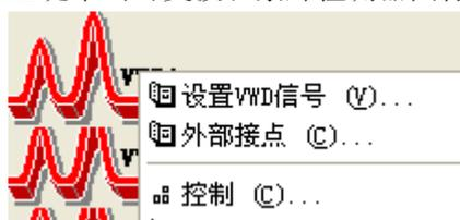
，点击“设置 VWD 信号”或者点击“仪器”的下拉菜单“设置 VWD 设置信号”后进入可变波长紫外检测器的参数设置菜单
