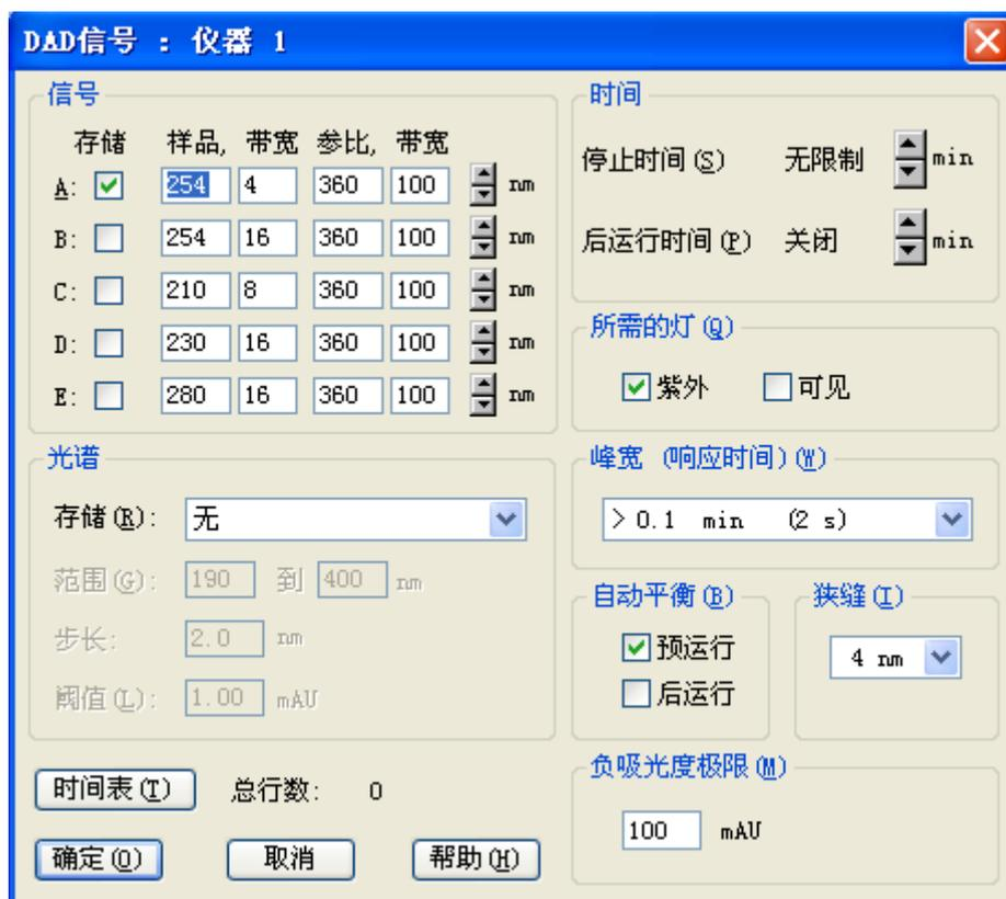
**信号**——样品：检测到的样品吸光度所对应的波长。参比波长对应的吸光度将从样品波长对应的吸光度中扣除；带宽：样品波长的带宽。带宽决定了检测吸光度的波长范围通常小于 20nm，例如，样品波长为 254nm，样品带宽为 20nm，则从 244 到 264nm 的波长范围检测吸光度；参比：参比吸光度对应的波长。参比波长可以补偿由于基线吸光度中的变化(例如，由于梯度洗脱中溶剂组成的变化)而引起的波动；带宽：参比波长的带宽通常设定为小于 100nm。G1315A/B 二极管阵列检测器可以存储 5 个信号；G1315C/D 二极管阵列检测器可以存储 8 个信号
