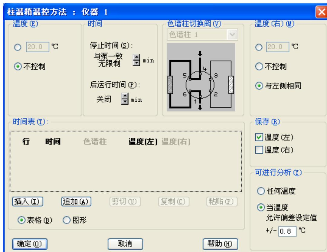
**可进行分析**——在任何温度下，选项可以指定是否开始分析与柱温箱温度无关；当温度在设定值之内，可以指定仅当温度位于指定的温度范围内时才开始分析
