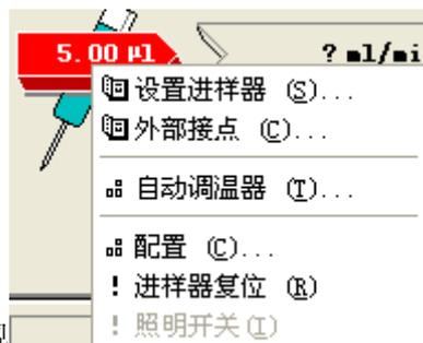
左键单击自动进样器图标，出现，点击“自动调温器”或者点击“仪器”的下拉菜单“更多进样器”后进入“样品自动调温器”的参数设置菜单
