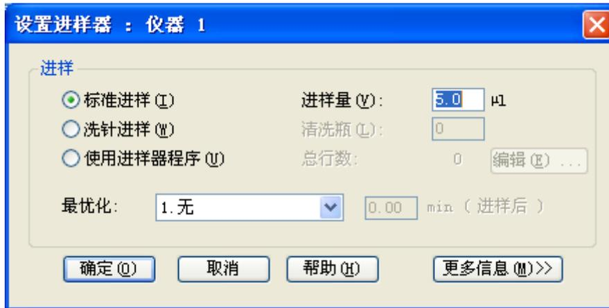
[标准进样](#)---简单的进样，在“进样量”字段中制定进样量。进样量取决于自动进样器的配置设置
