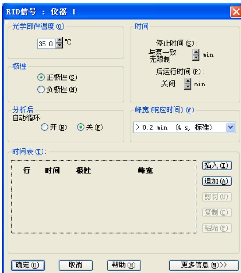
**光学部件温度**——设置光学设备温度。限值：高出环境 5 度到 55 度之间，建议为高出环境 5 度，以提高基线稳定性
