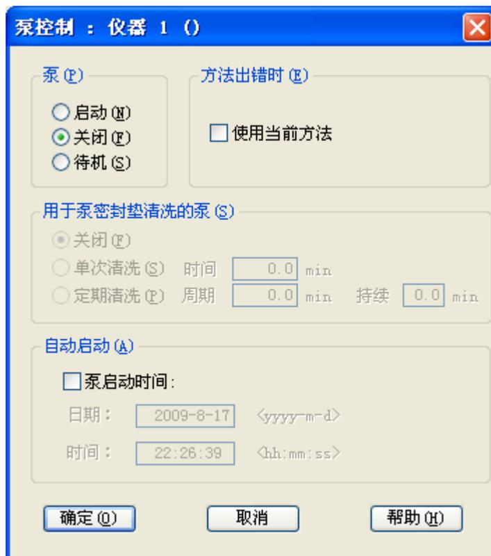
泵——控制泵的“启动”，“关闭”或者“待机”状态
