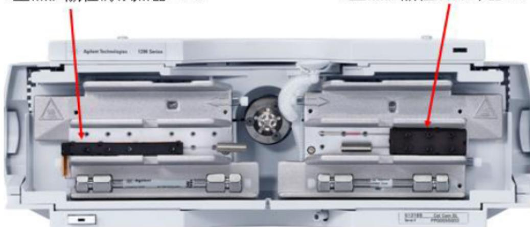
未接低扩散柱的柱温箱：左面， $3\ \mu\text{l}$
