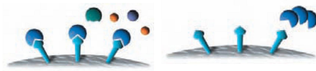
图 2. 亲和层析原理图（左图样品通过亲和介质时，目标分子被吸附在介质表面的亲和配基上；右图为洗脱时，目标分子从亲和配基上解离）
