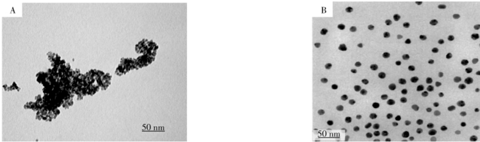
图 3 超声分散前(A)后(B)纳米 ATO 的 TEM 图
