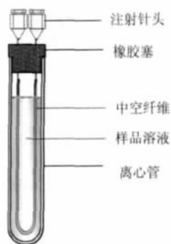
图 1 中空纤维离心超滤装置
