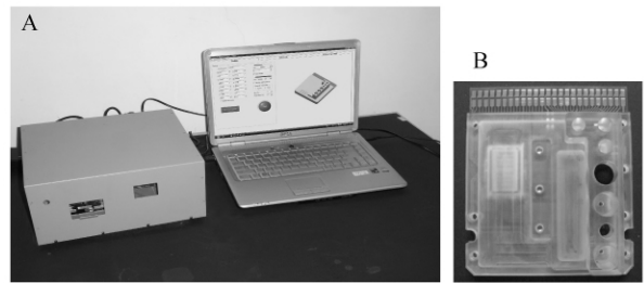
图 1 磁敏传感器检测仪(A)及配套磁敏传感器测试卡(B)(50 mm × 40 mm)
