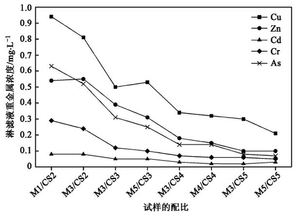
图4 固化污泥的重金属浸出浓度变化
