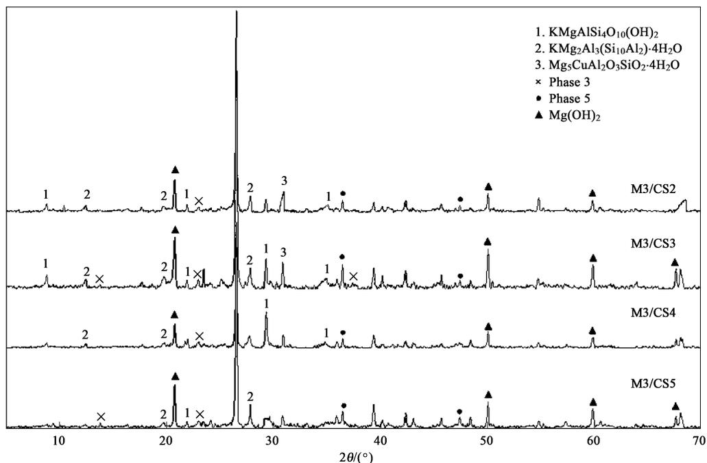
图 5 污泥试样的 XRD 图
