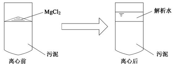
图1 污泥氯化镁脱水示意
