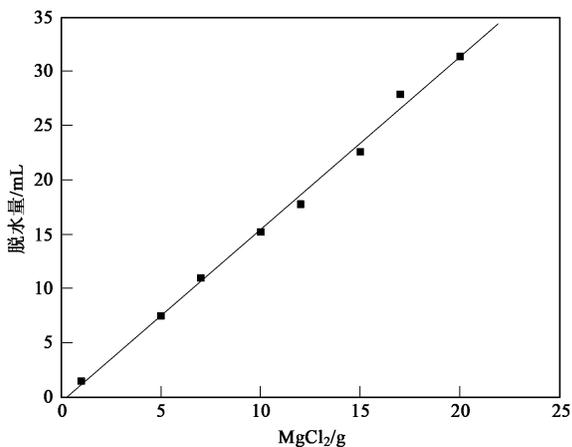
图 2 氯化镁与脱水量的关系
