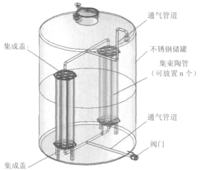
图1 集束式陶管不锈钢罐结构图
