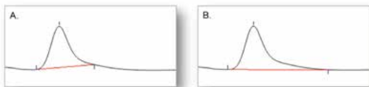
图 14. A) 由于拖尾导致的不正确积分，B) 使用 Cobra 得到的正确积分
