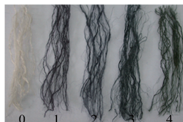
图1 蚕丝在京尼平溶液中的染色
