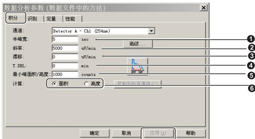
在 [ 积分 ] 标签中，可以调整积分参数，并确定最适合的值。可以在 [ 色谱图视图 ] 中检查更改的结果。更改每一字段的值，并找出最适合的积分参数。
