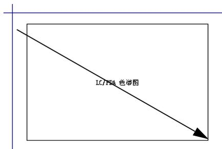
在工作区中，将光标从要粘贴项目的区域的起点拖放到终点。在区域的终点处松开鼠标按钮，出现 [LC/PDA 色谱图属性] 屏幕。
