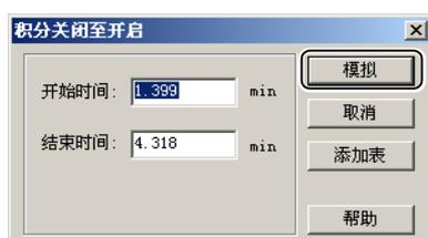
使用已设置的积分程序执行分析，在色谱图上显示基线和面积值。
