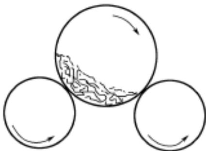
图 2-7 抗磨耗性试验滚筒系统
