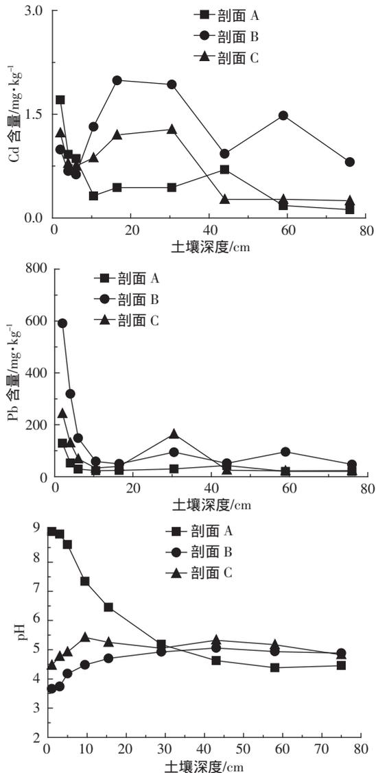
图3 剖面中 Tl、Cd、Cu、Zn、Ni、Pb 含量以及 pH 值
