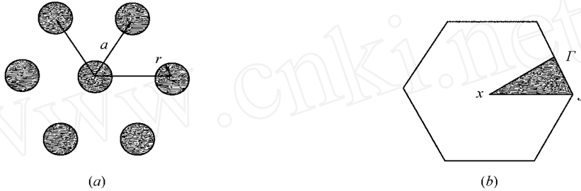
图 1 二维三角格子光子晶体结构 (a) 及三角格子的第一 Brilluin 区 (b)
