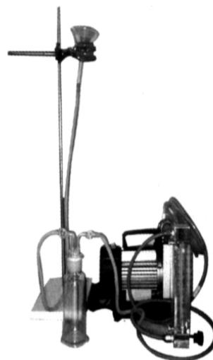
图1 环氧乙烷空气采集装置
