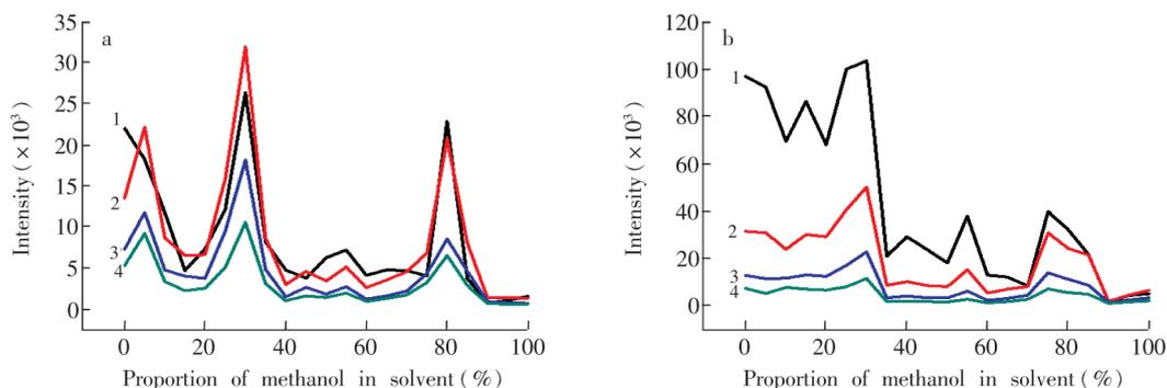
图2 溶剂组成对组织样品中磷脂物质信号的影响。癌症组织(CA)(a)与癌旁组织(CAB)(b)中(1)二棕榈酰磷脂酰胆碱( $m/z$  757, [DPPC + Na]<sup>+</sup>); (2) 1-棕榈酰基-2-油酰基磷脂酰胆碱( $m/z$  783, [POPC + Na]<sup>+</sup>); (3) 二油酰磷脂酰胆碱( $m/z$  809, [DOPC + Na]<sup>+</sup>); (4) 和花生四烯酰-硬脂酰磷脂酰胆碱( $m/z$  833, [SAPC + Na]<sup>+</sup>)的信号强度随萃取剂中CH<sub>3</sub>OH含量的变化情况
