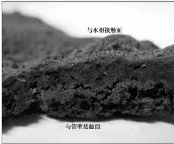
图4 DN100 铸铁管段管垢外观特征
