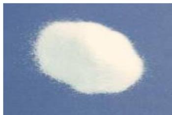
**Florisil (硅酸镁载体) PR (散装吸附剂)** 弗罗里硅固相萃取柱
