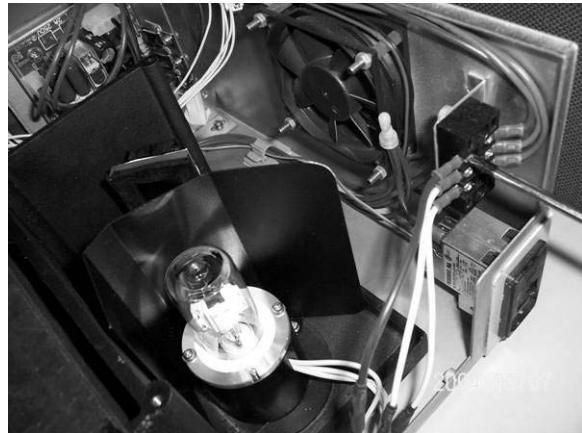
(6) 旋下固定氘灯的两个螺钉，取下氘灯，如图 6-5 所示：
