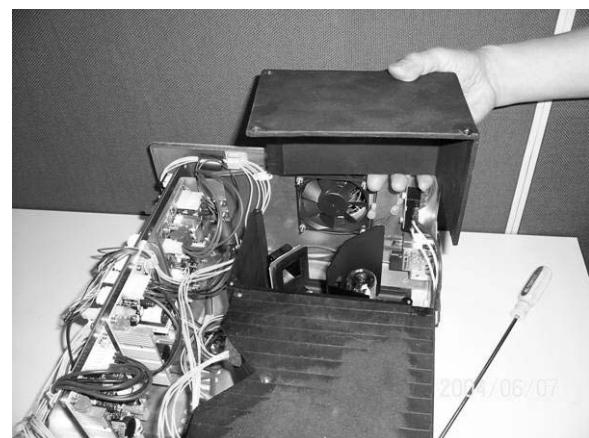
(5) 如图所示，从接线架上取下保护盖，旋下氘灯电缆的三个叉形电源端子，：
