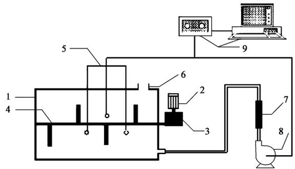
1. 发酵仓; 2. 电机; 3. 减速机; 4. 搅拌桨(轴); 5. 探头;
