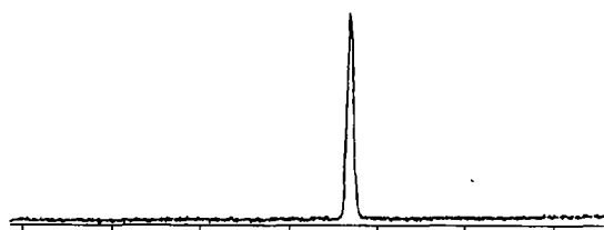
图3 顶空固相微萃取法测得实际样品的甲苯选择离子色谱图
