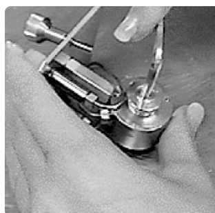
拆卸流通池窗口
