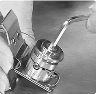
第三步：取出流通池螺钉，并取出垫圈。
