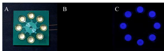
图 3 无线电化学发光电极阵列芯片照片 (A) 无二极管芯片的电化学发光照片 (B) 有二极管芯片的电化学发光照片 (C)
